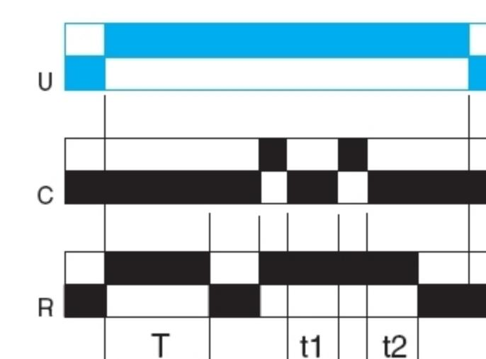
При подаче питания на реле времени выход R замыкается на время выдержки Т, затем возвращается в исходное положение.
