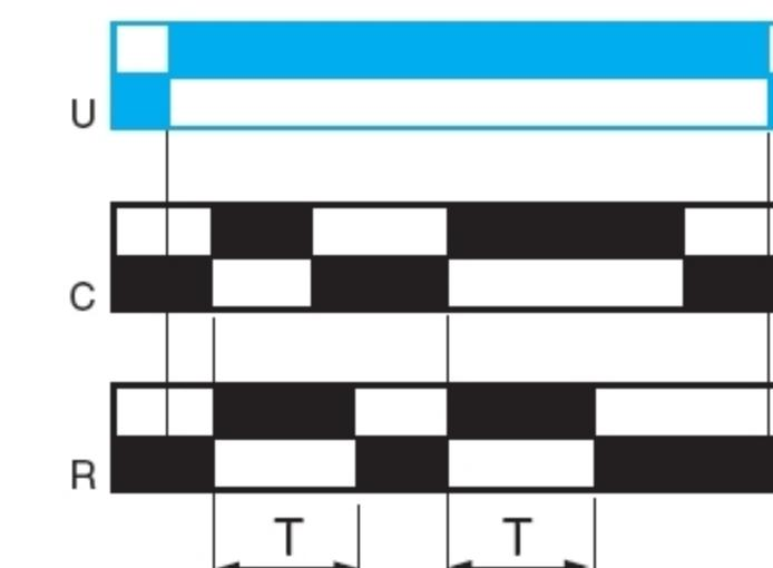
После подачи питания на реле времени, а затем импульса или непрерывно напряжения на управляющий вход С начинается отсчет выдержки времени Т.
