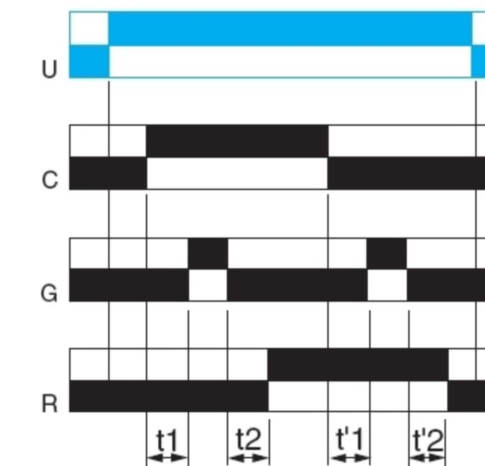
После подачи питания на реле времени, а затем напряжения на управляющий вход С начинается отсчет выдержки времени Т (отсчет можно прерывать подачей напряжения на вход прерывания G).
