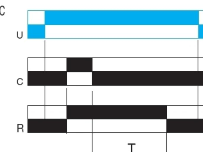
После подачи питания на реле времени и последующей подачи напряжения на управляющий вход С, выход R замыкается.
