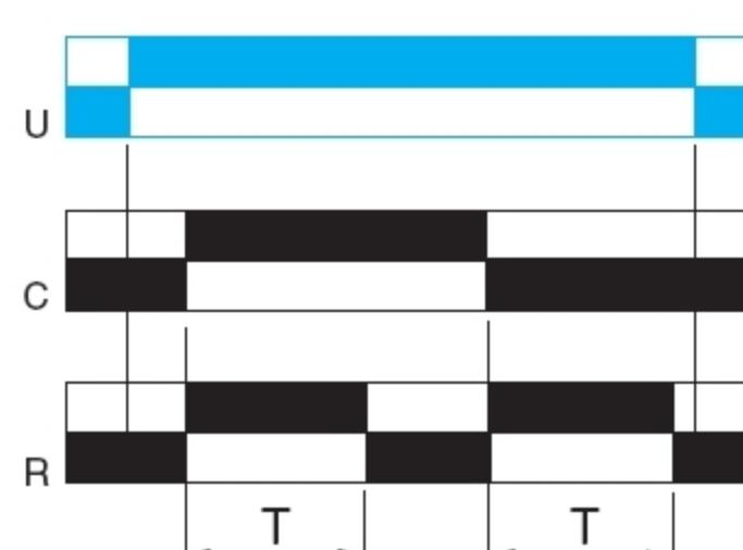
В момент подачи напряжения, а также в момент снятия напряжения с управляющего входа С начинается отсчет выдержки времени Т, в течение которого выход R замкнут.
