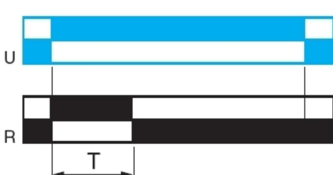
При подаче питания на реле времени начинается отсчет выдержки Т и замыкае(ю)тся выход(ы) R.
