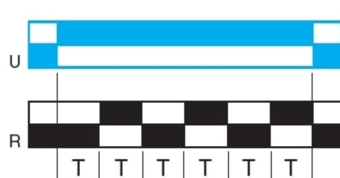
Повторяющийся цикл с двумя выдержками времени Т равной длительности, выход(ы) R меняе(ю)т свое состояние в конце каждой выдержки времени Т.
